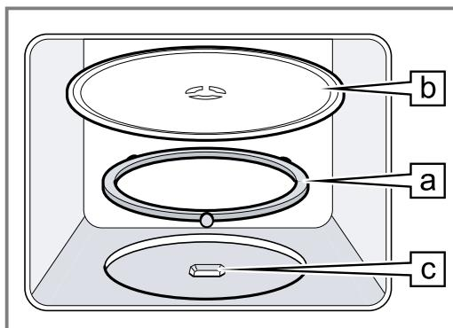
2. Encaixe o prato rotativo **b** no acionamento **c**, no centro do fundo do interior do aparelho.
