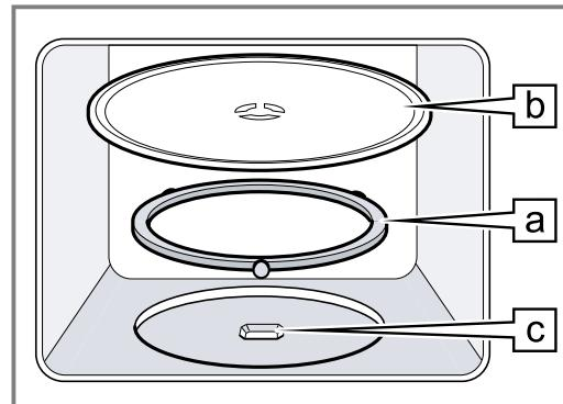
2. Döner tablayı **b**, pişirme bölümü tabanının ortasındaki **c** tahrığine oturtunuz.
