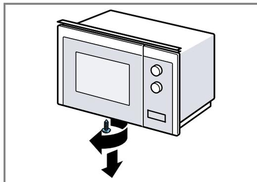
2. Retirar la cubierta de la base del microondas.
